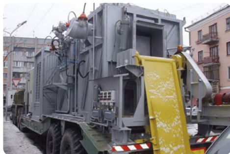
Пересувна установка для спалювання пестицидів
